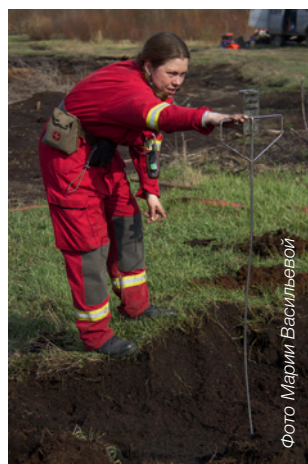
Рис. 24. Контроль качества тушения с использованием щупа-термометра. Смоленская область
