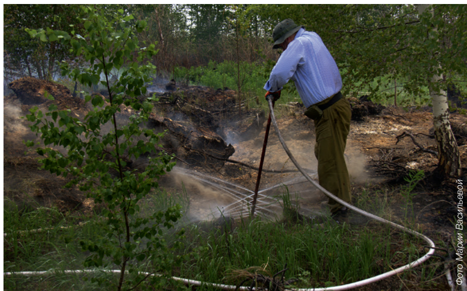
Рис. 16. Использование торфяного ствола ТС-1 на начальной стадии тушения бывшего торфяного штабеля. Впоследствии этот участок будет размыт компактными струями из ручных стволов. Владимирская область
