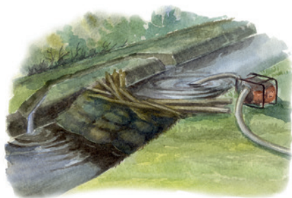
Рис. 56. Создание временной плотины для увеличения количества воды в водоёме. Автор: Татьяна Хакимулина
